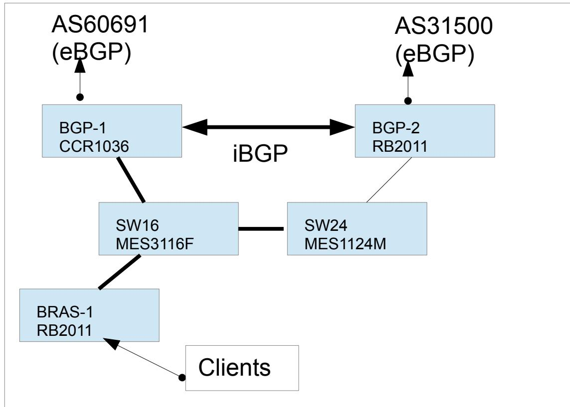
Неожиданное достижение в данной ущербной конфигурации — пример использования MikroTik RB2011 со 128MB памяти в качестве BGP-border-router. Достижение сомнительное, но оно показывает что можно смоделировать в реальных условиях всю эталонную модель почти не выкладываясь в оборудование и развивать ее по мере необходимости, просто покупая оборудование и производя его замену без перерывов связи.
